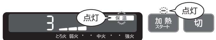
4 **切** を押すと保温を停止します。冷却ファン停止後、電源プラグを抜いてください。
