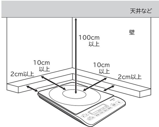
※実際の設置では、後面にマグネットプラグがあるので約10cmの距離が必要となります。
