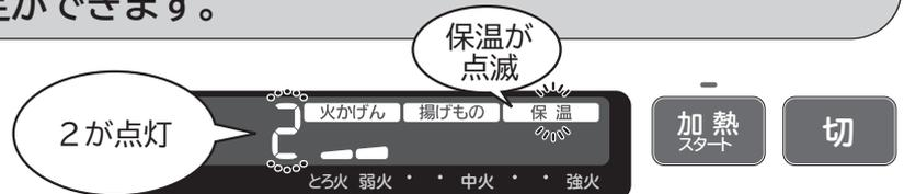
2 **下げる | 上げる** を押して調理に合わせて保温温度を調節します。
