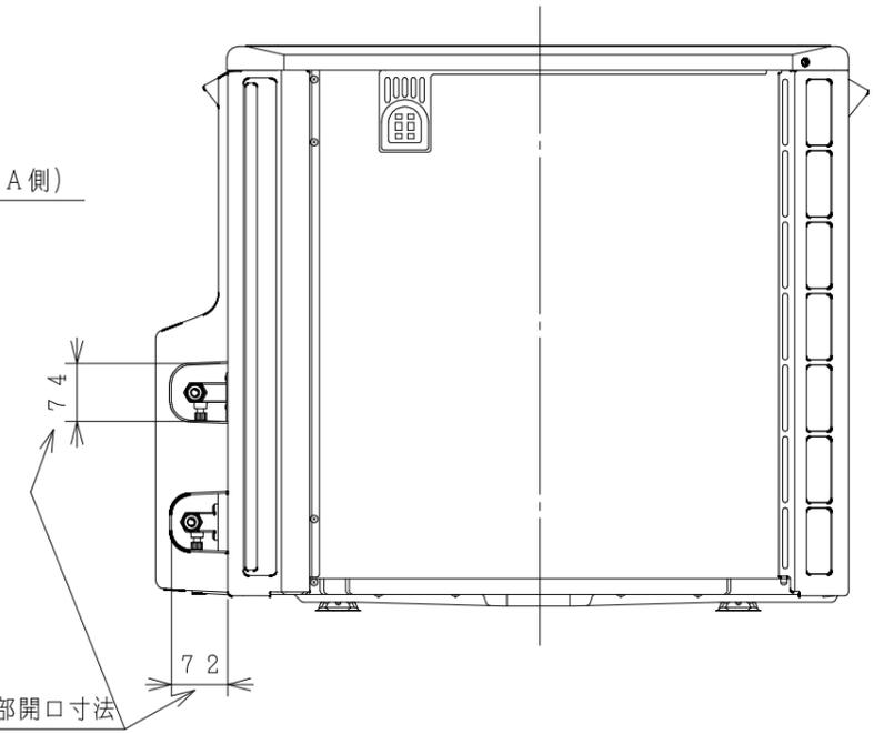
出湯配管の取出部開口寸法
