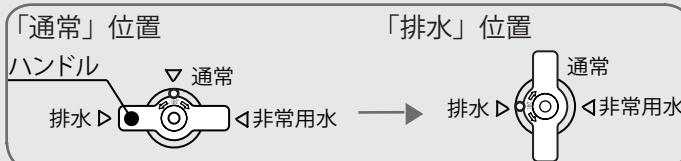
貯湯タンクユニットの水を排水します。排水口から水があふれないようタンク排水栓の開き具合を調節してください。
