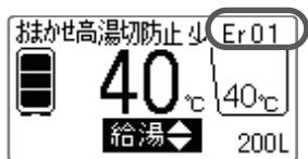
なお、時刻表示部に点検表示が残りバックライトが点滅します。
