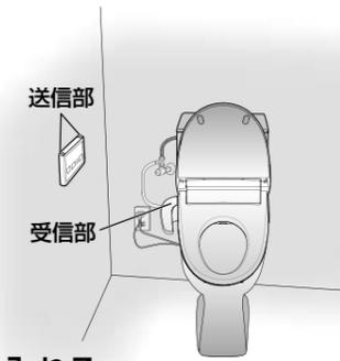
リモコンと天井の間に棚などの障害物がない位置に取り付けてください。
