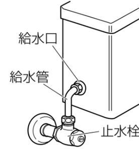
ロータンクの給水口と止水栓の間の距離が短く本体同梱の分岐金具とフレキシブルパイプが接続できない、給水管が外れない、ストレーナーがある場合は、別売の分岐水栓を下記に従って接続してください。
