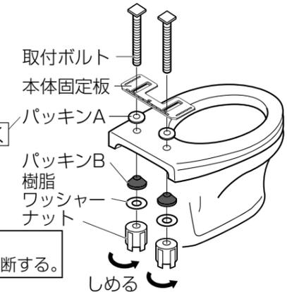
1. 位置を決め、取り外した固定部品、固定ねじを使用し、本体固定板を便器に仮締めする。
