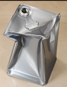
一斗缶の内部を0.8気圧に減圧すると、まるで、はみがきチューブのように潰れてしまった。真空チルドルームは、これだけの強い圧力に耐え得る素材と耐圧構造に設計されている。
