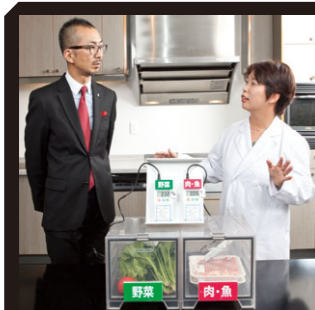
野菜と肉をそれぞれ同じ条件のボックスに入れて密閉し、CO 2 センサーでCO 2 を検知する実験を実施。その結果、野菜が入っているボックスの数値だけが、元の数値(肉・魚の0.05%)と比べて約6倍の0.32%にまで上がった。
