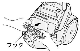
取り付け状態(ボール紙をフックの取り付け線に合わせる)
