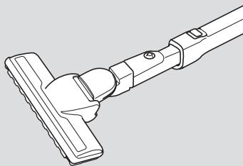
回転ブラシに異物の噛み込みなどがある状態で運転を続けると、パワーへッドモーターの過熱を防ぐために、自動的に回転ブラシの回転を停止します。
