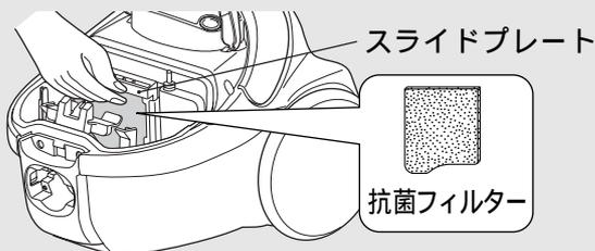
**2** 抗菌フィルターを水で軽く押し洗いし、たたいて水気を切り、十分に自然乾燥させる
