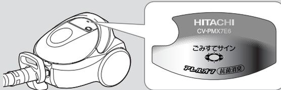
「ごみすてサイン」が点滅したまま運転を続けると、本体モーターの過熱を防ぐために、電力を抑える保護運転になることがあります。さらにこの状態で運転を続けると、自動的に運転を停止します。
