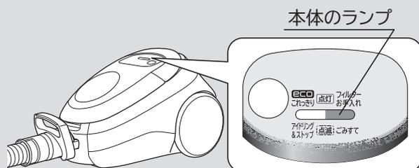
本体のランプが赤点灯したまま運転を続けると、本体モーターの過熱を防ぐために、電力を抑える保護運転になることがあります。さらにこの状態で運転を続けると、自動的に運転を停止します。
