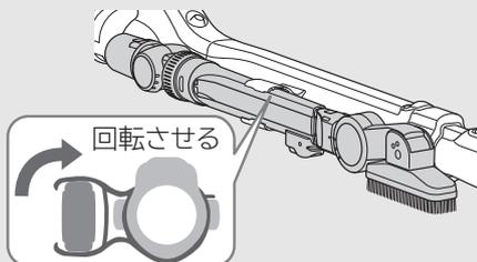
**3** ワイド曲がるロング吸口の穴をストッパーに合わせて押し込む
