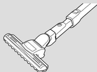
回転ブラシに異物を挟み込むなどした状態で運転を続けると、パワーヘッドモーターの過熱を防ぐために、自動的に回転ブラシの回転を停止します。
