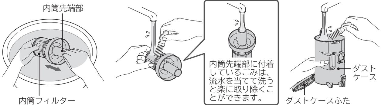
内筒先端部を矢印の方向に動かして水洗いしてください。
