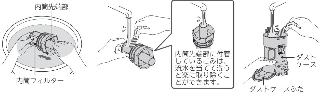
内筒先端部を矢印の方向に動かして水洗いしてください。
