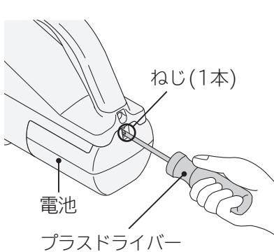
**2** 電池を引き出し、電池と本体をつないでいる橙色のリード線を、電池から約2cmの位置でニッパなどで切断し、ビニールテープを巻いて絶縁する
