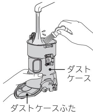
内筒先端部を矢印の方向に動かして水洗いしてください。
