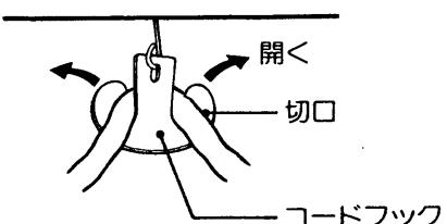
※工場出荷時は取り付けてあります。テーブルとして使うなど、電源コードをはずしたときは、必ずコードフックに取り付け直してください。
