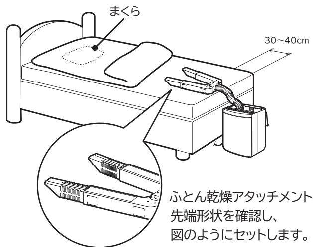
ふとん乾燥アタッチメントの先端形状を確認し、図のようにセットします。
