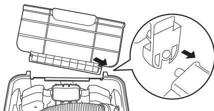
②左側ふたの軸受け溝に本体軸をふたを縦にした状態で下方向にカチッとなるまで押し込む。
