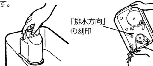
図のように、本体に刻印されている排水方向に本体を静かに傾け、排水します。
