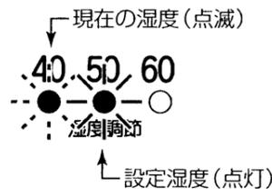
湿度センサーを安定させるため、現在の湿度が設定湿度より高いときでも、運転スタート後、しばらくの間は強制的に加湿します。
