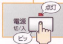
※切/スタートキーを押した後、約30秒以内に火力設定キーを押さないとブザーが鳴り、自動的に解除されます。
