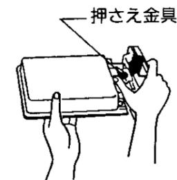
グリル皿を逆さにして図のように持ち、押さえ金具を矢印方向に押すとはずれる。皿、ドアを落とさないよう注意する。
