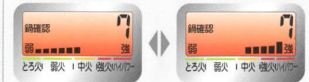
※表示窓の液晶表示が赤く点灯し、「鍋確認」を表示します。 ※約30秒後メロディーが鳴り表示が消え、通電を停止します。
