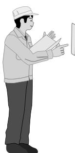
□ 台所リモコンの動作を確認してください。リモコンの見方・操作方法を説明し、設定項目をお客様と相談して適切に設定してください。（給湯温度、沸き上げ設定、湯切れ防止設定など）
