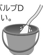
⑥～⑨の水抜きは、ビニールホース(現地準備品:内径8mm以上)などを使用して、バケツ等へ排水を導いてください。
