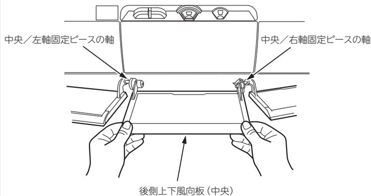
⑥ 後側上下風向板(右)を左に移動して室内機の軸から外します。
