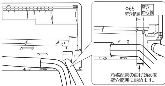
冷媒配管の曲げ始めが壁穴範囲から出ていると、曲げが大きくと、室内機が壁から浮き上がり、仕上りが悪くなる原因となります。
