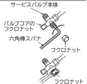
フレアナットは手締めでは冷媒漏れを防げません。スパナを使用してしっかり締め付けてください。
