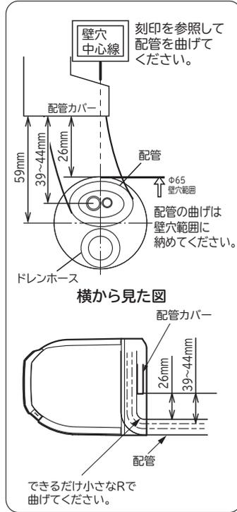
配管の曲げ始めが壁穴範囲から出ている、曲げRが大きいと、室内機が壁から浮き上がり、仕上りが悪くなる原因となります。
