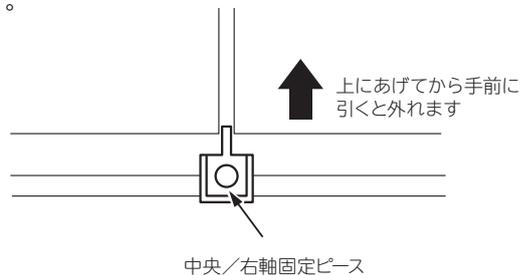
⑤ 後側上下風向板(中央)を手前に引きながら後側上下風向板(右)(左)から固定ピースの軸を抜いて外します。
