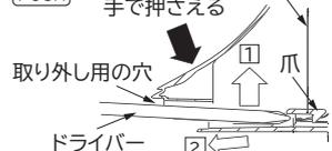
手で押さえる      据付板      取り外し用の穴      爪      ドライバー
