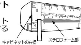
※室内機の下部を手前に浮かして、室内機の背面で冷媒配管を接続する作業が難しい場合があります。この場合は、P.15「フロントパネル・化粧カバーの取り外し・取り付け」を参照し、化粧カバーを取り外して配管の接続を実施してみてください。
