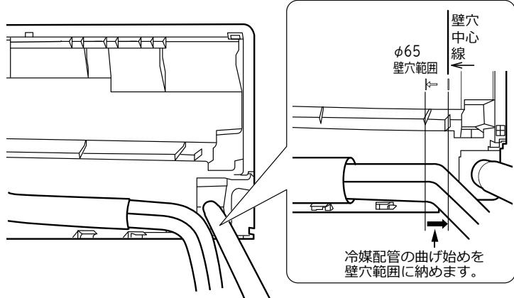
冷媒配管の曲げ始めが壁穴範囲から出ていたり、曲げRが大きいと室内機が壁から浮き上がり、仕上りが悪くなる原因になります。
