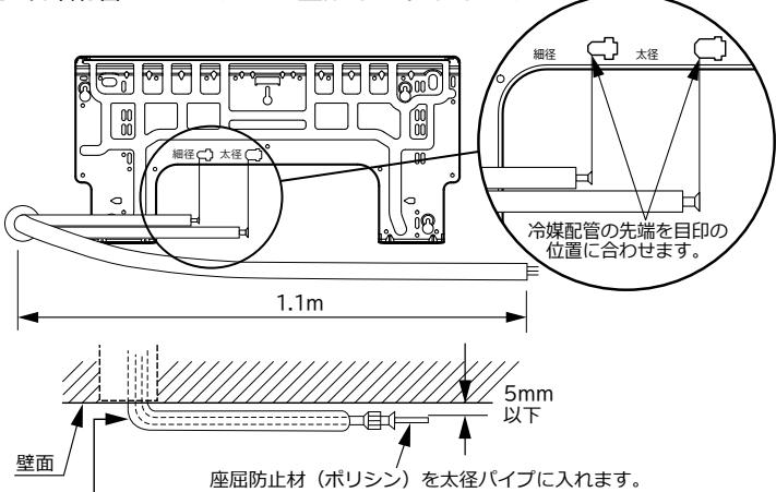
できるだけ小さなRで曲げてください(座屈防止材(ポリシン)を使用すると配管を潰さずに小さなRで曲げることができます)。
