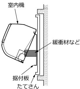
**必ず、下図記載の刻印 -1- 部5ヵ所を付属ねじ5本で固定し、据付板は水平に固定する。**
