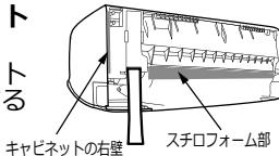
※室内機の下部を手前に浮かして、室内機の背面で冷媒配管を接続する作業が難しい場合があります。この場合は、P.15「フロントパネル・化粧カバーの取り外し・取り付け」を参照し、化粧カバーを取り外して配管の接続を実施してみてください。
