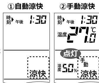
現在室温と調節した温度との差で、一定時間ごとに冷房・断続または一時停止・涼快を切り替えます
