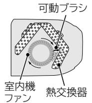
2 熱交換器・可動ブラシを凍結洗浄で洗い流します
