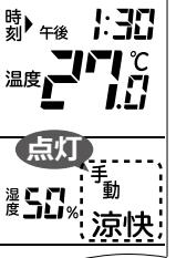
現在室温と調節した温度との差で、一定時間ごとに冷房・断続または一時停止・涼快を切り替えます
