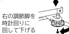
右の調節脚を時計回りに回して下げる
