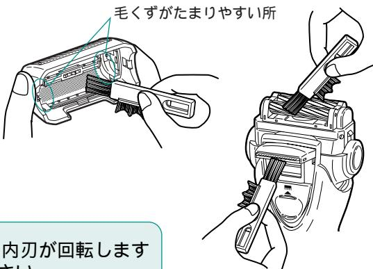
2 外刃、内刃、キワゾリ刃および本体を掃除する。特に外刃内側の両端は毛くずがたまりやすいので十分に掃除する。
