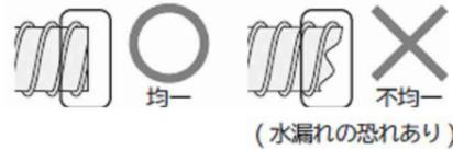
(2) 切断部にアダプター、ホースフック、またはLパイプを接着剤で取り付け、排水口に接続する。部品の使い分けは据付説明書の「排水ホースの接続のしかた」をご覧ください。
