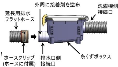
(2) 糸くずボックスを洗濯機の排水口の位置よりも低い安定した水平な場所に設置する。
