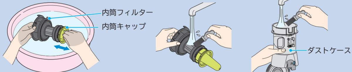
内筒キャップを矢印の方向に10回程度動かして水洗いしてください。
