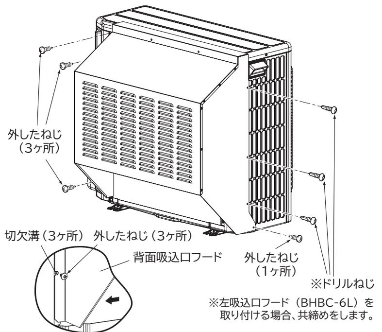
※切欠溝(3ヶ所)は、背面吸込口フードを矢印の方向に押しつけながら、外したねじで固定して下さい。
