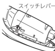
4 電池ケース側面にあるスイッチレバーをはずす。
