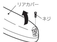
2 リアカバーのネジ1本を⊕ドライバーではすして、リアカバーの下側(矢印部)を開くようにしながらはずす。
