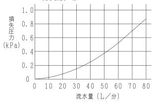
(注)流水抵抗曲線の説明 流水量 :砂こし器の入口から出口に流れる水量(L/分) 損失圧力:砂こし器の入口と出口の圧力差を現したもの(k P a)
