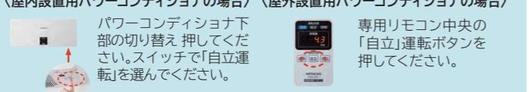
停電時、昼間に発電している場合は、非常用電源として携帯電話の充電・ラジオ・テレビ・ノートパソコン・電気ポットなどが使用できます。非常用電源として使う場合は、パワーコンディショナを「自立運転」に切り替え、使用電力量をご確認の上、家電製品をご使用ください(AC100V、合計1,500Wまで、日射量により使用できる電力量は変動します)。※夜間など日射がなく発電しない場合は使用できません。※モーターを作動する機器は起動時に大きな電力が必要なため「自立運転」時には使用できません(エアコン・洗濯機・冷蔵庫・ポンプなど)。※日射量によっては途中で発電が止まることがあるため生命に関わる機器は「自立運転」時に使用できません。
