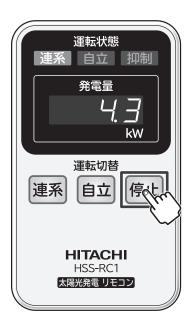
重系運転を停止させたい場合 は、専用リモコン右側の「停止」 ボタンを押してください。 発電電力表示が消え、「連系」運転 ランプが消灯し、運転を停止し ます。
