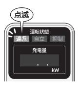
全年開始後、表示部に発電電力を表示し、「連系」運転ランプが 点灯します。
