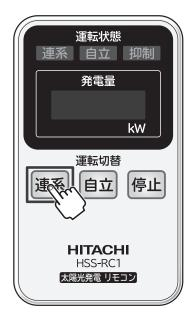
専用リモコン左側の「連系」運転 ボタンを押すと「連系」運転ラン プが点滅します。
