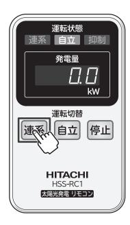
専用リモコン左側の「連系」運転 ボタンを押すと「連系」運転ラン プが点滅します。 表示部に■・・・・・(ドット表示)が 点灯し、約5分後に連系運転に 切り替わります。
