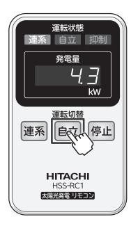
専用リモコン中央の「自立」運転 ボタンを押すと「自立」運転ランプ が点滅します。 表示部に■■■■(ドット表示)が
