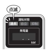
連系運転開始後、表示部に発 電電力を表示し、「連系」運転 ランプが点灯します。
