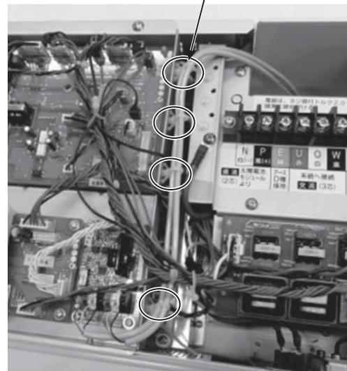
⑦⑥項で通信用ケーブル端子No.2(右側3個)に接続した通信用ケーブルのもう一方の端部は次に接続するパワーコンディショナの通信用ケーブル端子No.1(左側3個)に接続してください。
