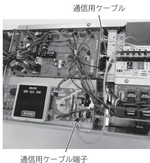
通信用ケーブル端子No.1(左側3個)の上のボタンを押しながらリード線の先端を差し込んでください。
