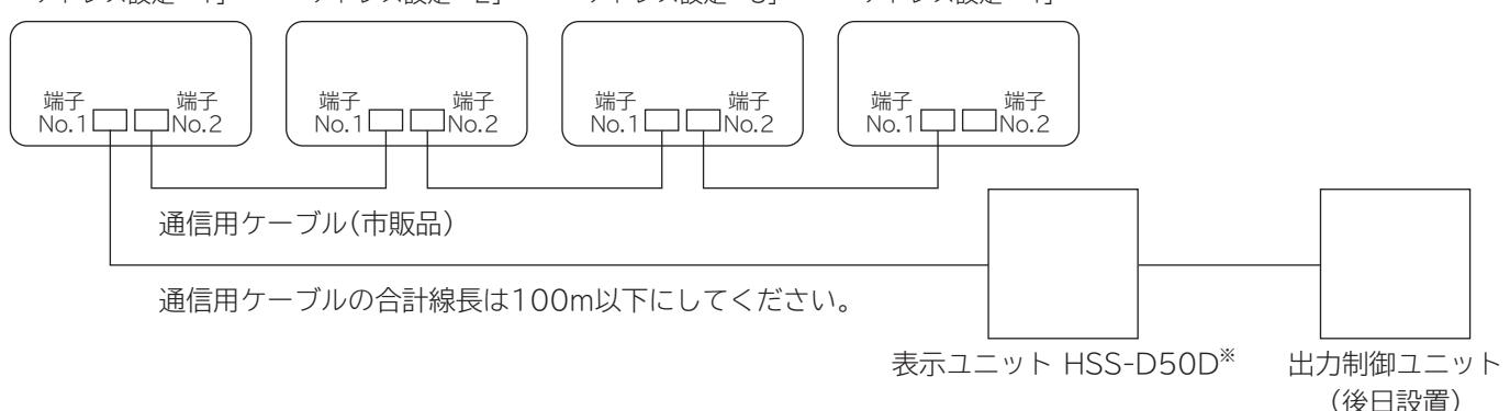
※表示ユニットHSS-D50Dの表示部による発電電力や消費電力の表示が不要の場合はパワーコンディショナと出力制御ユニットを直接接続することもできます。
