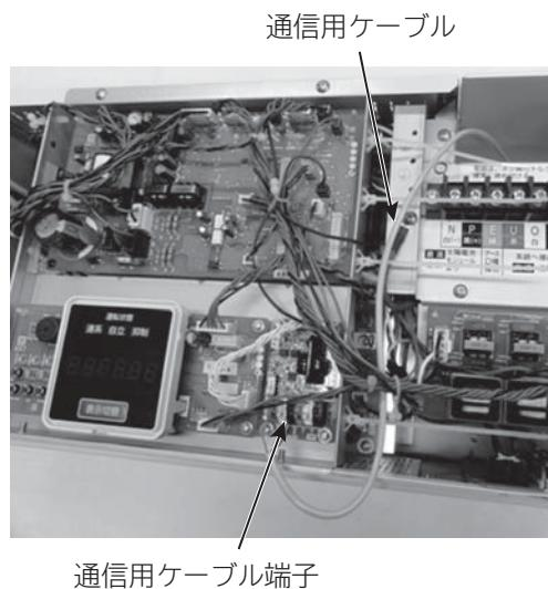
通信用ケーブル端子No.1(左側3個)の上のボタンを押しながらリード線の先端を差し込んでください。
