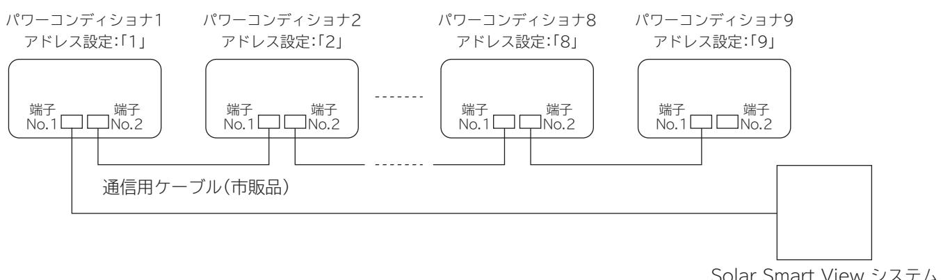
通信用ケーブルの合計線長は100m以下にしてください。
