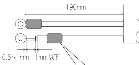
圧着をする前に予め圧着端子キャップを電線に通しておき、圧着後は配線用圧着端子のカシメ部分が隠れるように取り付けてください。
