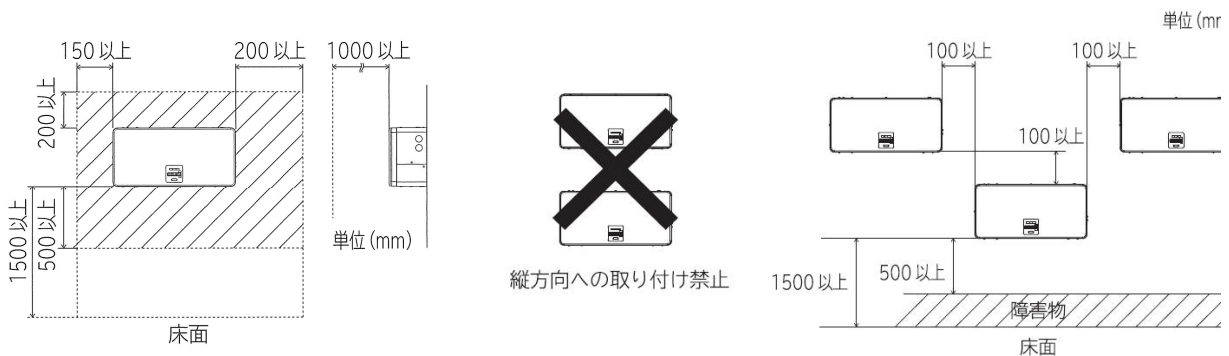
図 7 - 2 壁面取付時の製品同士および周囲との最低スペース（多数台取付け時）
