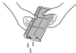
使用を続けると水トレイ内部や、加湿(気化)フィルター表面に白または茶色の水あかが付着します。水あかは水道水に含まれるミネラル分が気化せず残ったものです。お手入れせずに使い続けると固まって取れにくくなり、加湿量の低下につながります。
