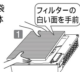
フィルターはフィルターの側面に表示してある「手前」の矢印がパネル側に向くようにセットしてください。
