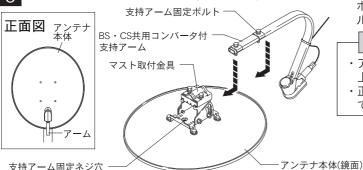
アンテナ本体裏のマスト取付金具に支持アーム固定ボルト2本をしっかりと締め付けます。(適正締付トルクは2.94~3.92N·m (30~40kgf·cm)です。)
