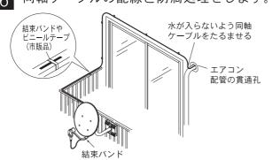
1 エアコン配管の貫通孔などに同軸ケーブルを通します。 通した後は、水が入らないように貫通孔をふさいでください。
