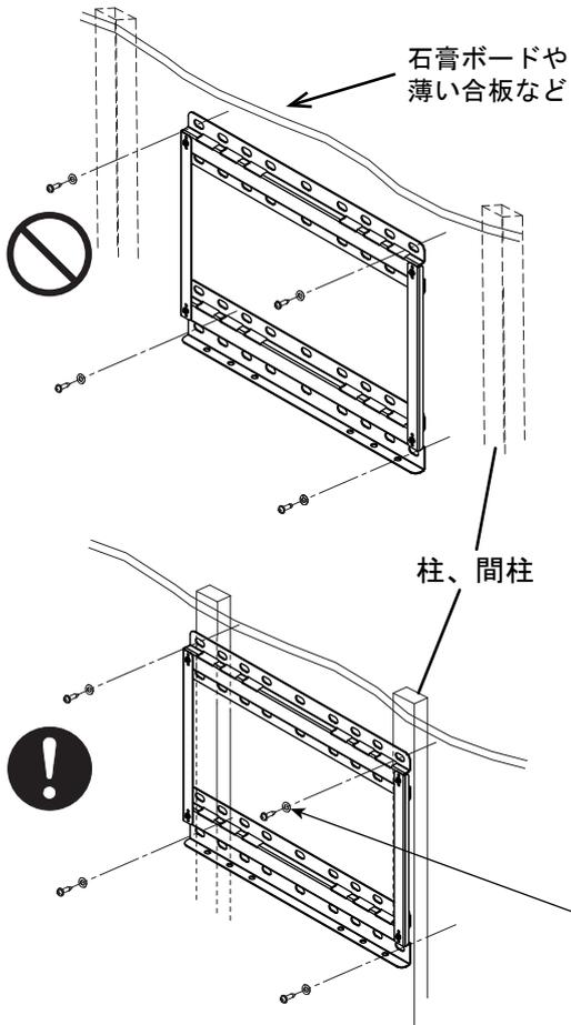
■壁掛けユニットを設置する壁面は、液晶テレビと壁掛けユニット等の総合荷重に長期間十分耐え、また、地震や想定される震動や外力に十分耐える施工を行ってください。
