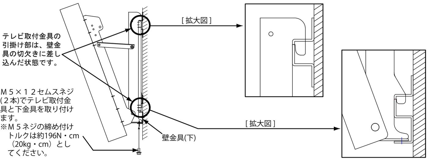
テレビ取付金具の引掛け部は、壁金具の切欠きに差し込んだ状態です。
