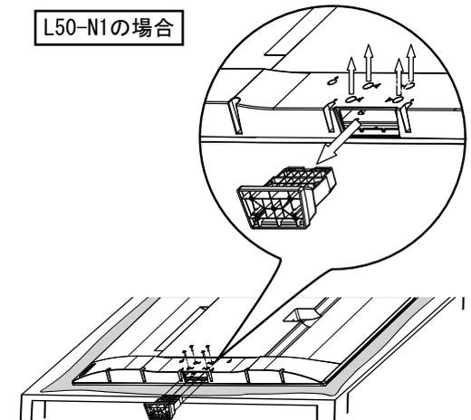
※形状は異なりますが、同様にスタンド固定用のネジ4本を取り外して、支柱を下に引き抜いてください。
