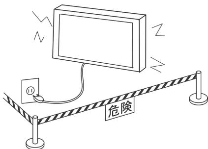
■異常が発生したら液晶テレビの電源プラグを抜き、人が近寄れないよう処置してください。
