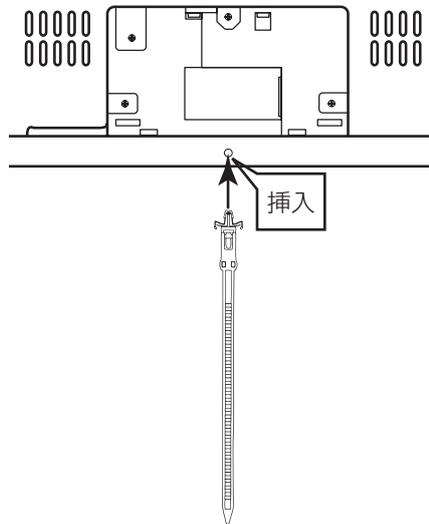
②テレビに電源コード、HDMI ケーブルを差し込みます。電源コードはフェライトコアがテレビの下に出ないように、図のようにスタイル取りしてケーブル結束バンドでしばります。
