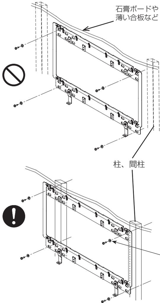
■壁掛けユニットを設置する壁面は、液晶テレビと壁掛けユニット等の総合荷重に長期間十分耐え、また、地震や想定される震動や外力に十分耐える施工を行ってください。
