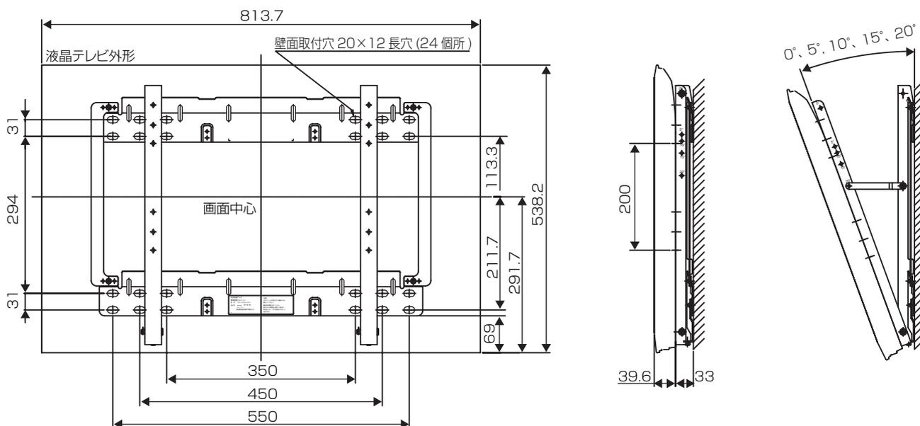
4. 壁取付金具を壁面にしっかりと取付けてください。
