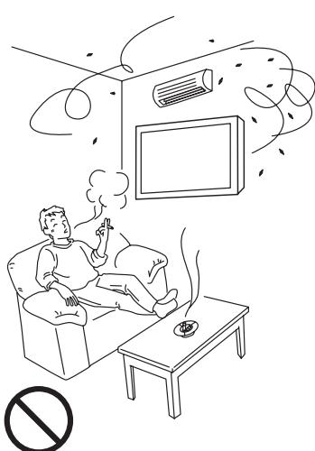
■ エアーコンディショナーの吹出し、吸込み口のそばに取付けないでください。
