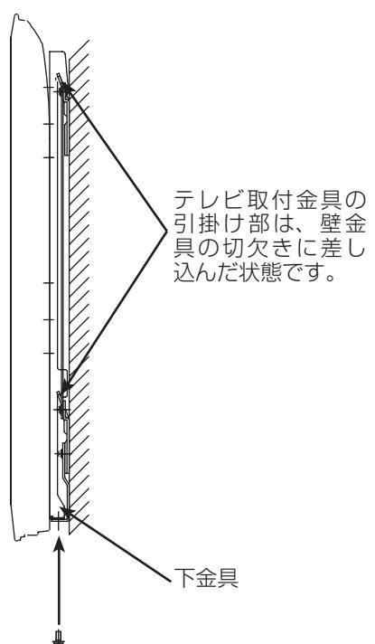
$M5 \times 12$  ネジ (2本) でテレビ取付金具と下金具を取り付けます。
