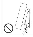
■設置後のケーブル類の抜き差しは、テレビを壁に 取付けたままの状態では 行わないでください。
