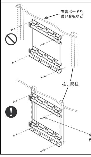
■壁掛けユニットを設置する壁面は、液晶テレビと 壁掛けユニット等の総合荷重に長期間十分耐え、 また、地震や想定される震動や外力に十分耐える 施工を行ってください。
