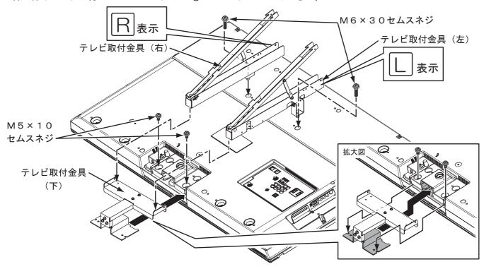
③、テレビ取付金具(右)、(左)とテレビ取付金具(下)を付属のM4×8セムスネジ(6本)で取付けてください。
