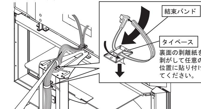
※ケーブル類を固定する際には、回転に支障のないよう、十分なたるみを持たせて固定してください。
