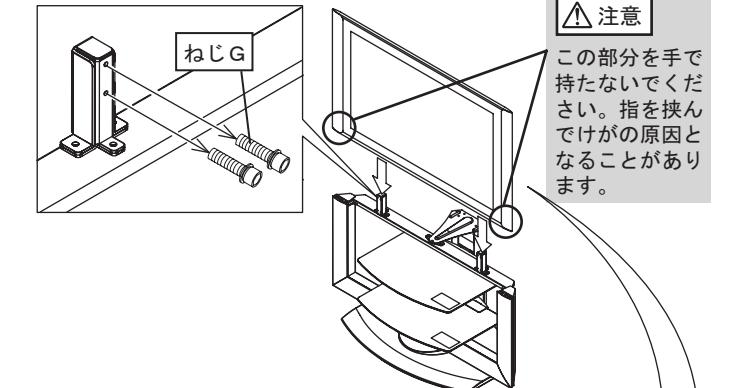
裏面からはずしたねじG(4本)でテレビを固定してください。ねじGの取り付けには付属の六角レンチをご使用ください。
