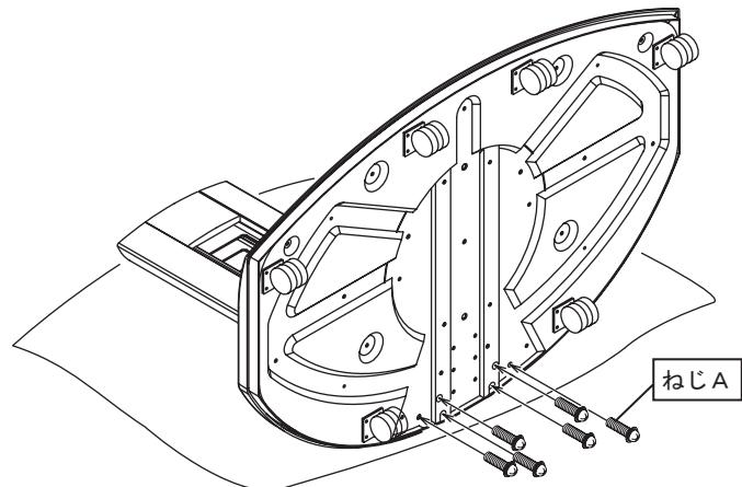
**注意** ねじAの締め付けの際は、ねじがまっすぐに入るように締め付けてください。ねじ山が破損してけがの原因となることがあります。
