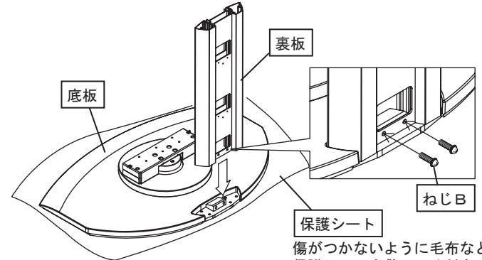
**注意** 製品及び床面の保護のため、設置の際は必ず毛布などの保護シートを敷いた上で作業を行なってください。
