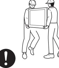
■設置作業は必ず2人以上で行ってください。重量物が落下してけがの原因になります。
