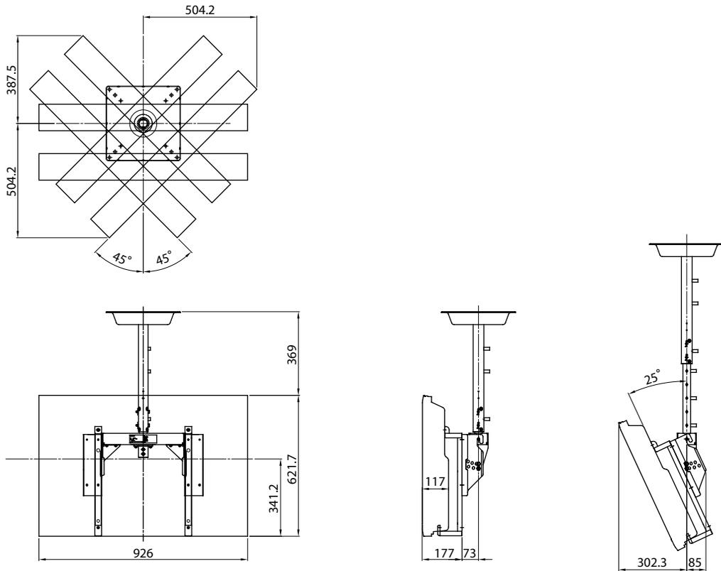
2、(P3)にてテレビに取り付けたアタッチメント金具に、テレビ取付金具(右)及び(左)を天吊りユニットに付属のM5×12ネジ4本で取り付けてください。
