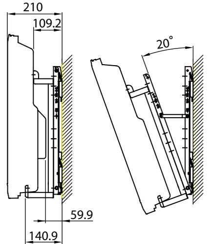
2、(P3)にてテレビに取り付けたアタッチメント金具に、テレビ取付金具を付属のM5×12ネジ4本で取り付けてください。
