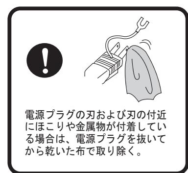
電源プラグの刃および刃の付近にほこりや金属物が付着している場合は、電源プラグを抜いてから乾いた布で取り除く。
