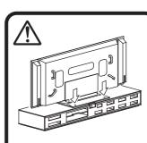
ネジ止めの箇所 はすべてしっかり と締め付ける。
